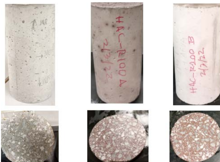
Figura 4. Probetas de las tres referencias y sus cortes transversales.
