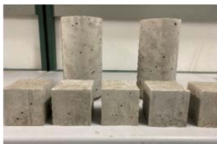
Figura 1. Probetas desmoldeadas HAC-C (izquierda) y HAC-100A (derecha).
