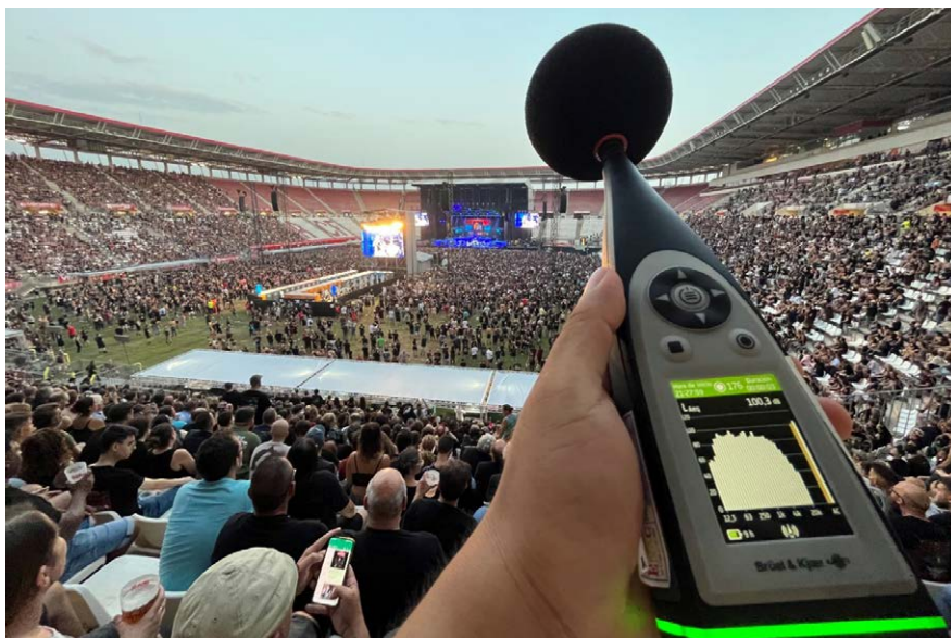
Medición del nivel sonoro de emisión de un concierto al aire libre.
