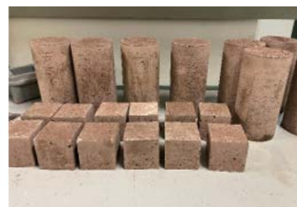
Figura 1. Probetas desmoldeadas HAC-C (izquierda) y HAC-100A (derecha).
