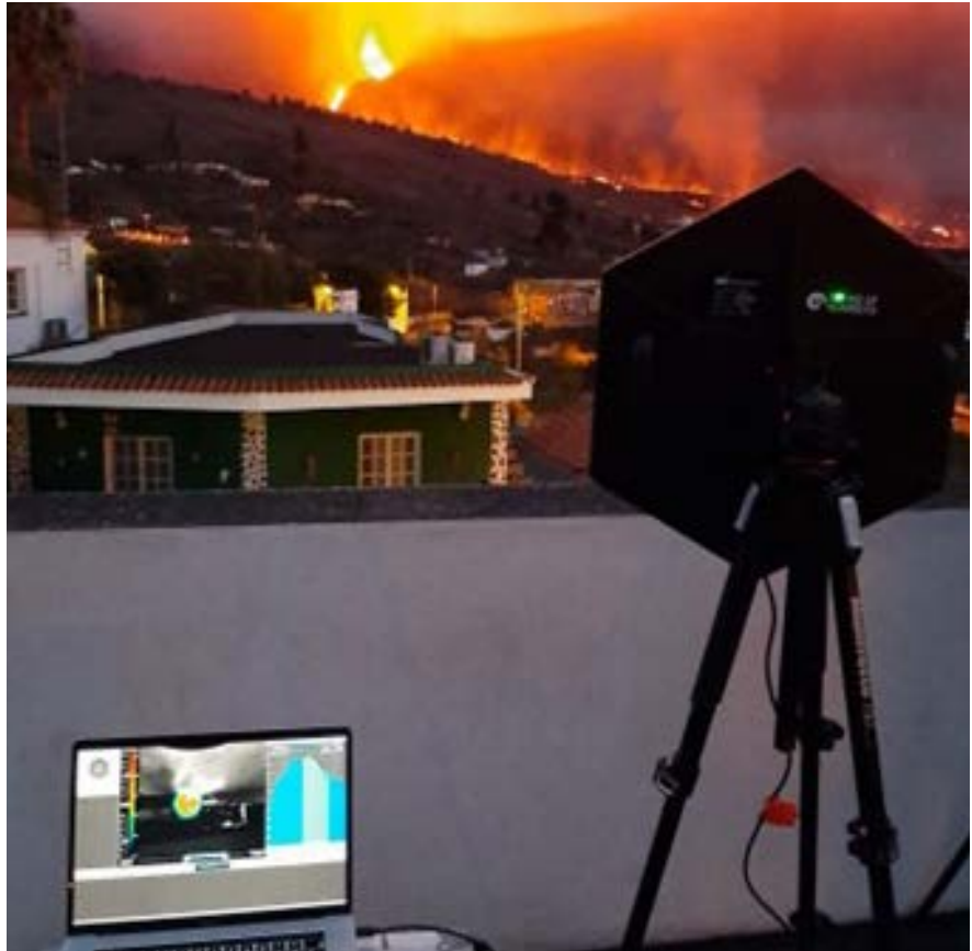
La cámara acústica, que incorpora 128 micrófonos, realiza una medición en la erupción volcánica de la isla de La Palma de 2021.
